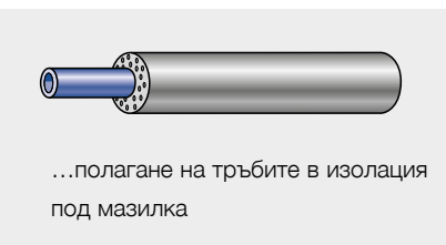
За топла вода скобата се монтира върху изолацията, с един размер по-голяма
