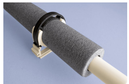
За топла вода скобата се монтира върху изолацията, с един размер по-голяма
