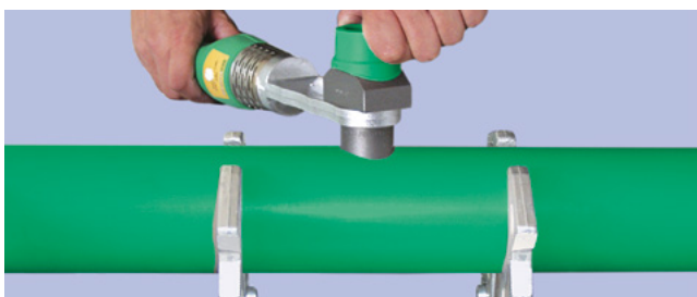
③ Поставяме седлото в накрайника така, че да съвпадат резките им. Нагриваме седлото и отвора. Времето за нагриване е дадено в табл. вдясно.
